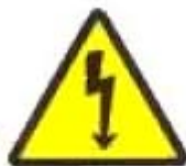
Señalización del Riesgo Eléctrico
