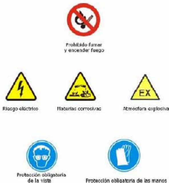
Señalización correspondiente a baterías de plomo ácido
