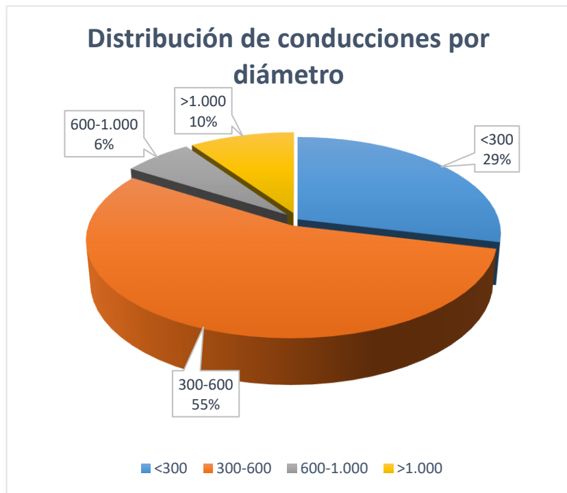
Figura 116. Distribución de colectores de saneamiento por diámetro
