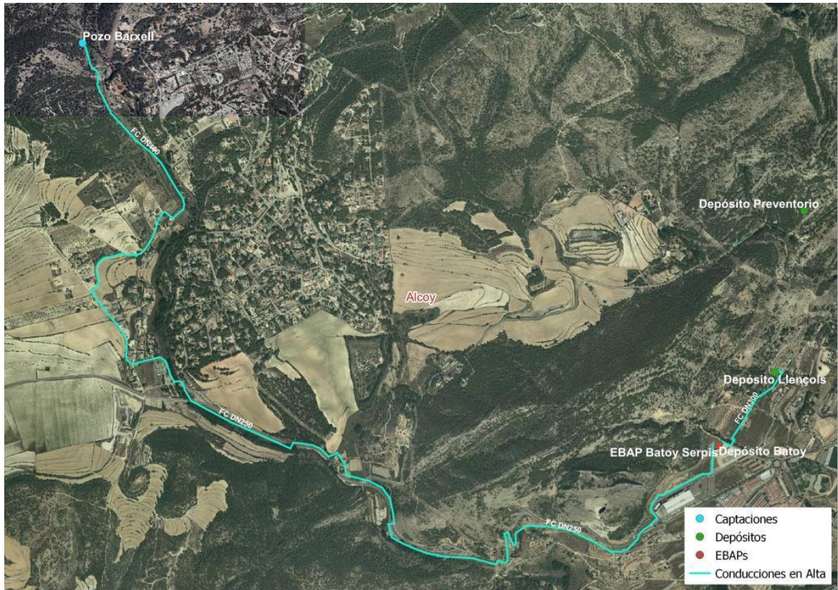
Figura 110. Conducción Pozo Barxell-Depósito Batoy-Depósito Llençols
