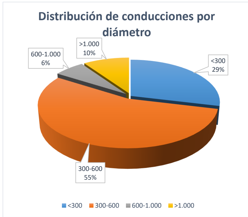
Figura 116. Distribución de colectores de saneamiento por diámetro
