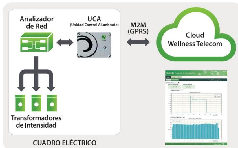
**Ilustración 4. Esquema de funcionamiento sistema de telegestión**
