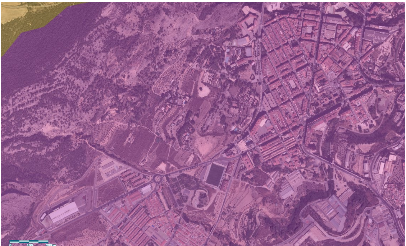
Riesgo de erosión potencial: Nivel 5, Muy alta >100 Tm/ha/año. Fuente Cartografía Temática de la Generalitat Valenciana
