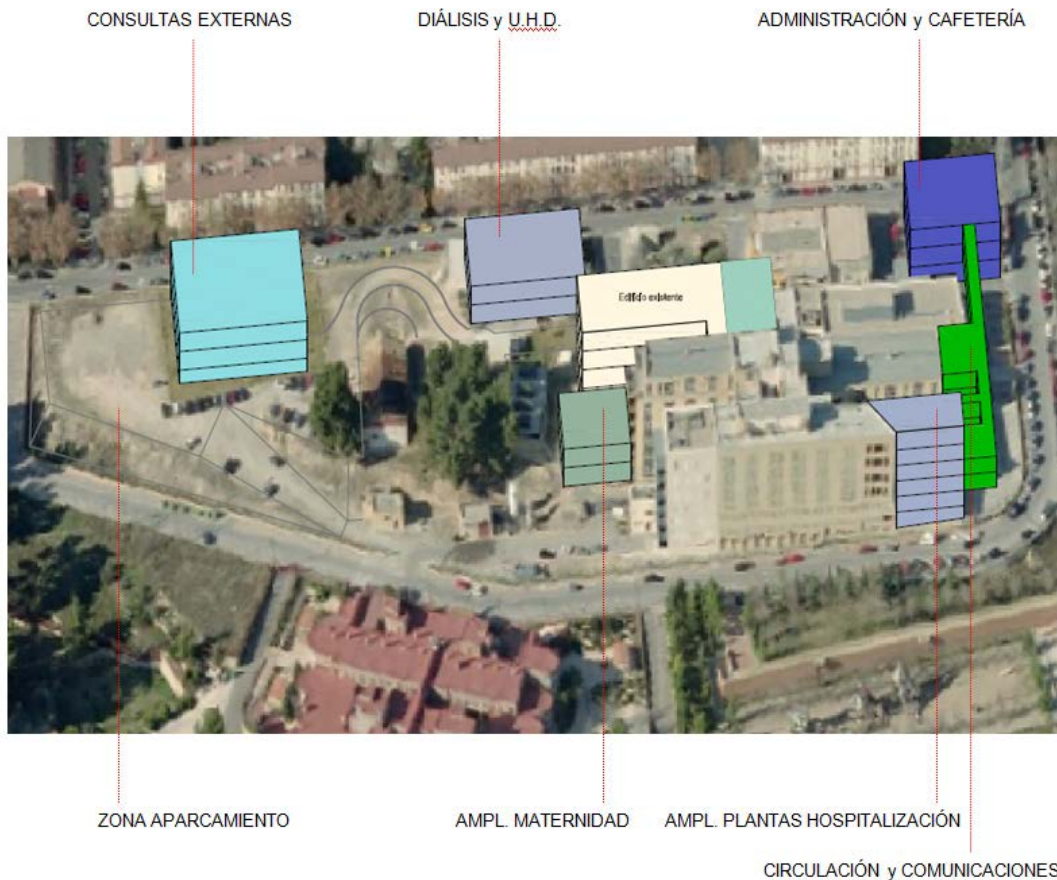
Imagen 2: Esquema volumétrico de la ampliación del edificio existente prevista en el Plan Director aprobado.
