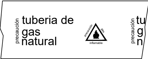
BANDA SEÑALIZADORA DE GAS
